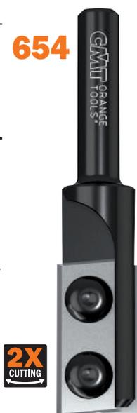
Fresa a taglienti diritti con due coltelli intercambiabili fissati da viti speciali TORX®. Il coltello superiore presenta un'affilatura di 3° per l'esecuzione di forature e tagli inclinati di precisione.
