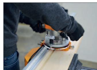
Iniziate la lavorazione spostandovi sulla morsa, tramite l'ausilio del vostro PGD-1. Otterrete un canale perfettamente lineare su tutta la lunghezza lavorata.
