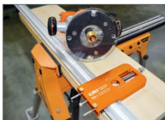
Montate sulla base in plastica la boccola di guida (grazie al relativo anello), quindi assemblate la base alla vostra fresatrice. Posizionate la morsa sul pezzo da lavorare e il vostro PGD-1, tramite le viti per la regolazione della battuta lo vincolerete alla morsa.
