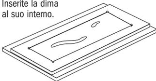
**3.** Posizionate la fresa all'interno della scanalatura di lavorazione e fresate con la regolazione di profondità della fresatrice sbloccata.
