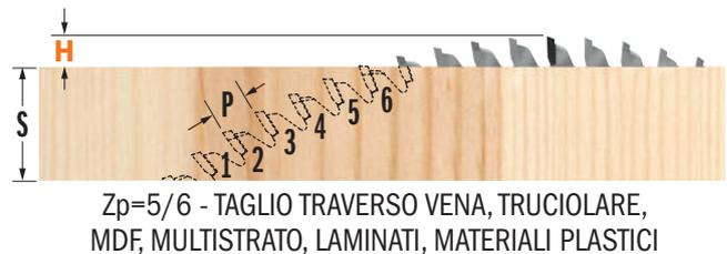
Il **Passo P** di una lama, ossia la distanza tra un dente e l'altro, si calcola nel seguente modo:
