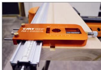
Se avete necessità di ottenere un canale più grande del diametro della fresa utilizzata, dovrete semplicemente spostare della misura desiderata, il foro di inserimento della fresatrice, tramite la vite di regolazione millimetrica.
