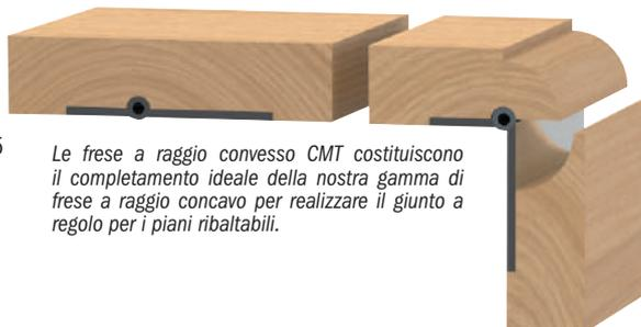
Le frese a raggio convesso CMT costituiscono il completamento ideale della nostra gamma di frese a raggio concavo per realizzare il giunto a regolo per i piani ribaltabili.
