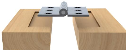
Ecco come incassare la tradizionale cerniera a cilindro utilizzando le frese per mortasare.
