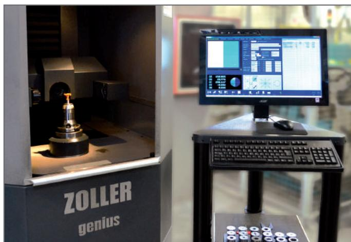
Il sistema di controllo CMT completamente automatizzato.
